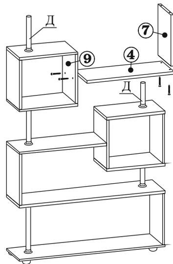
3.4. Аналогичным образом присоедините и закрепите второй короб. Следите чтобы трубы входили в штангодержатели и не забывайте фиксировать их стопорными винтами.
