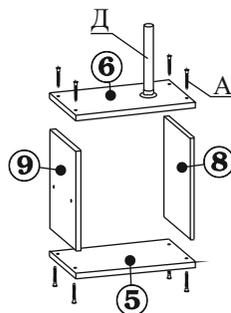
3.3. Установите полку (дет.№2). Следите чтобы труба вошла в штангодержатель. На деталь №2, установите трубу (поз.Д) и деталь №7. К детали №7 присоедините среднюю полку (дет.№4). К полученной конструкции присоедините короб, закрепив его винтовой стяжкой (поз.А) к детали №4, через деталь №9. Зафиксируйте трубы в штангодержателях.
