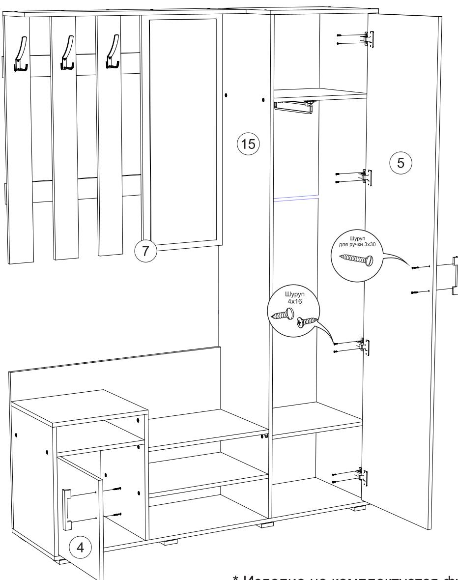
**10)** Закрепить петли на створки 4 и 5, используя шурупы 4x16. Навесить готовые створки, согласно инструкции, закрепив их шурупами 4x16. Установить ручки, используя шурупы для ручек 3x30. Отрегулировать зазоры и положение створок.
