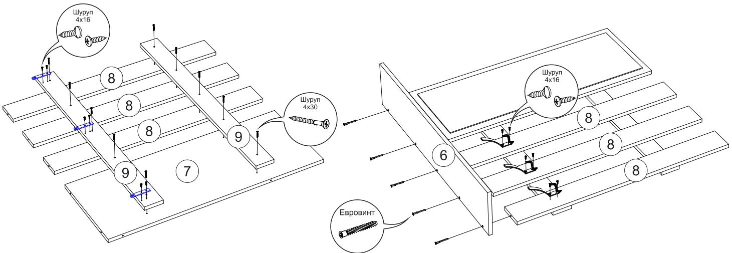
**8)** Закрепить на деталь 9 навесы, используя шурупы 4x16. Соединить детали 7, 8 и 9 шурупами 4x25, как показано в инструкции.
