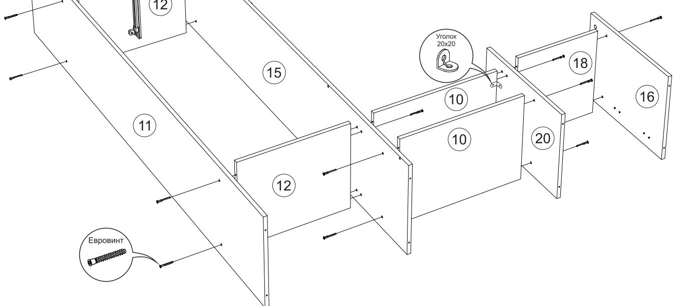
**4)** Закрепить крышку 14 к боковинам 11 и 15 евровинтами, крышку 17 к боковинам 20 и 16 эксцентриковыми стяжками. Соединить крышку 13 с боковинами 11,15,20 и 16 при помощи евровинтов.
