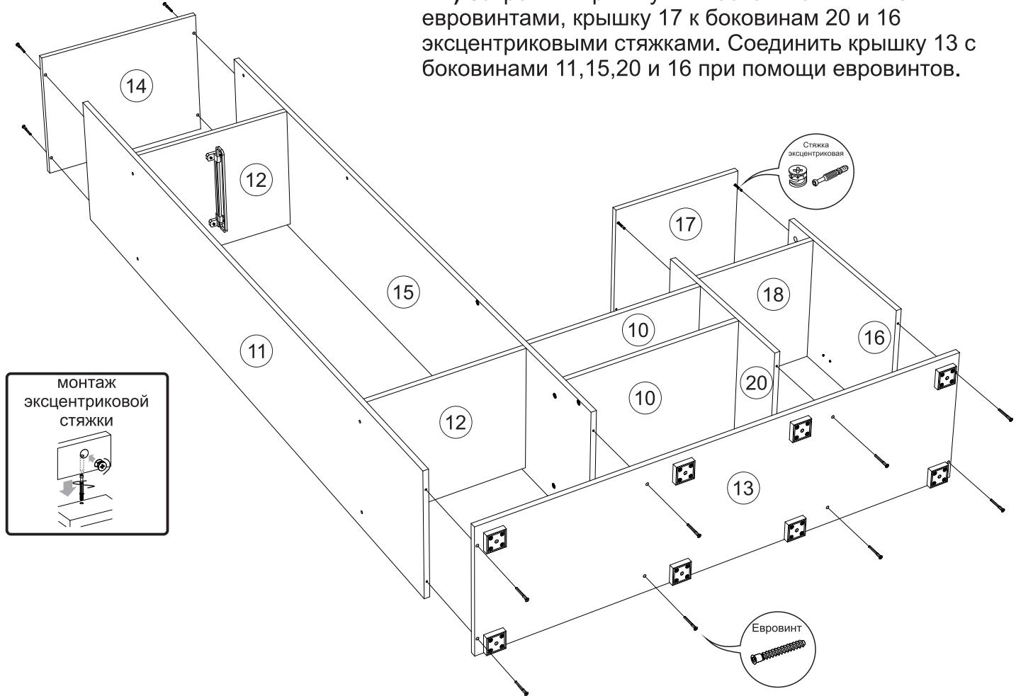
**5)** Для крепления задних стенок изделие необходимо положить на ровную поверхность тыльной стороной вверх.
