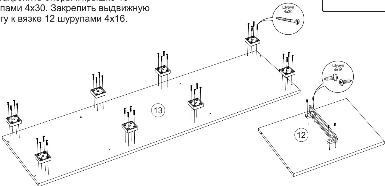
**3)** Соединить вязки 12 с боковинами 11 и 15, вязки 10 с боковинами 15 и 20, и вязку 18 с боковинами 20 и 16 евровинтами. Вязку 10 дополнительно закрепить уголками 20x20, используя шурупы 4x16.
