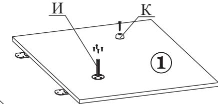
3.4. Соедините основную и откидную столешницы (дет.№1 и №2) секретерными петлями (поз.3) с помощью шурупов 3,5x13.
