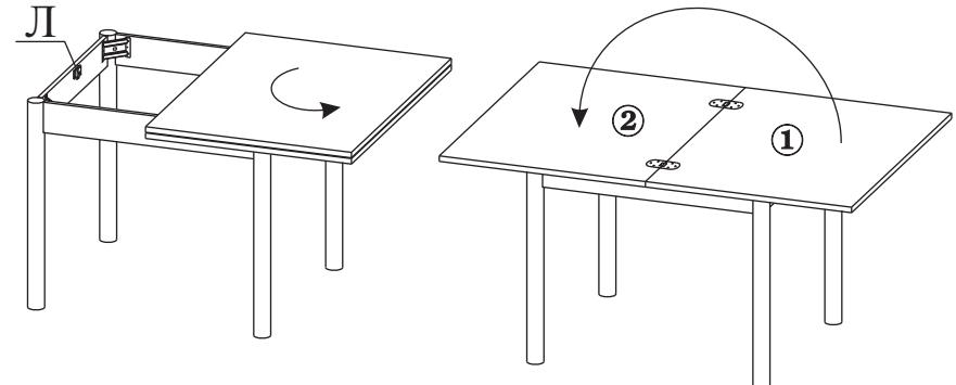
Во избежание произвольного сдвига столешницы, фиксируйте ее в крайних положениях с помощью кнопочных замков (поз.Л).
