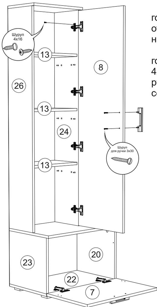
**15)** Закрепить петли к створке 8 шурупами 4x16. Навесить готовую створку, закрепив петли к боковине 24(26), в зависимости от стороны открытия, используя шурупы 4x16. Установить ручку на створку 8, закрепив ее шурупами для ручки 3,5x30.
