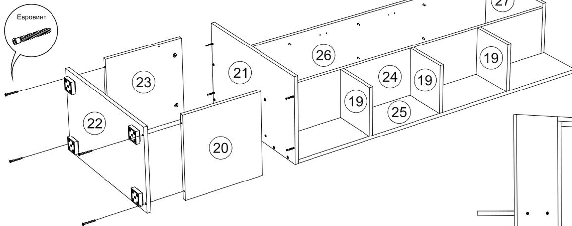
**14)** Закрепить задние стенки 1 к боковинам 24, 26 и крышкам 27, 21 гвоздями, предварительно выровняв диагональ при помощи рулетки и соединив панели 1 профилем 46. Закрепить заднюю стенку 5 к боковинам 20, 23 и крышкам 22, 21 гвоздями, предварительно выровняв диагональ при помощи рулетки.
