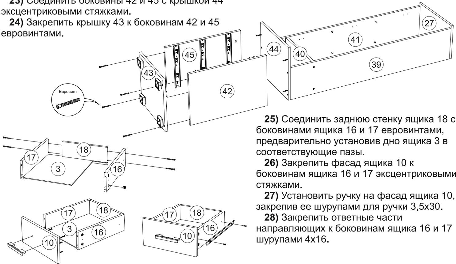
**25)** Соединить заднюю стенку ящика 18 с боковинами ящика 16 и 17 евроинтами, предварительно установив дно ящика 3 в соответствующие пазы.
