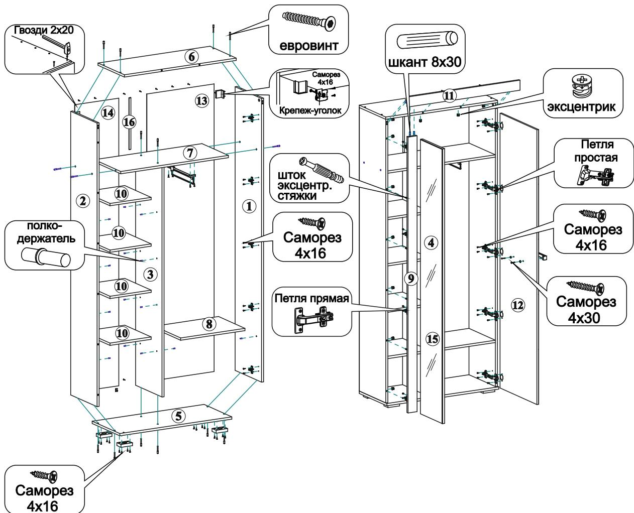
\*Для крепления ЛДВП применяются гвозди 2x20. Саморезами 4x16 крепятся петли и опоры. Штангодержатель выдвижной закрепляется саморезами 4x20. Если несколько модулей устанавливаются рядом, рекомендуем стянуть их между собой межсекционными стяжками просверлив предварительно отверстие диаметром 5 мм в произвольных местах.
