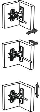
Сначала монтируются верхняя и нижняя петли, под которые есть разметка на боковинах, затем приворачивается средняя петля, под которую отверстия намечаются самостоятельно!
